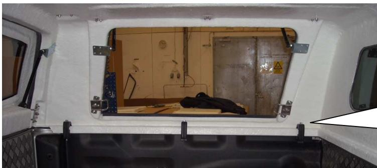
Drücken Sie die Haube seitlich gegen die Innenkante der Pritsche und befestigen Sie die Klammern wie auf dem Bild. Die Haube auf der Pritschenkante mit den Klammern festziehen mit **Max. 10Nm**.
