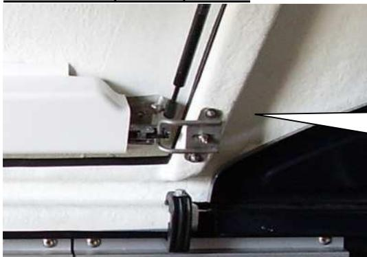
Kontrollieren Sie, dass die Klappen leicht zu schließen sind und dass die Schlösser richtig eingestellt sind. Bei Bedarf das Schloss und Schlossbügel nachstellen.
