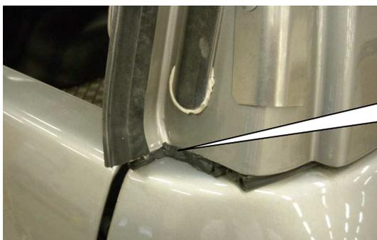
Applizieren Sie das Dichtungsband zwischen Top und Pritschenkante wie auf dem Bild gezeigt.
