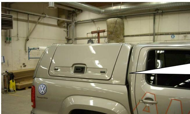
Heben Sie die Haube vorsichtig auf das Auto und schieben diese so nach vorne, dass das Vorderteil der Pritsche hierdurch gut abgedichtet wird.
