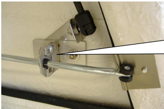
Kontrollieren Sie auch, dass die Klappen leicht zu öffnen und zu schließen sind, und dass die Schlösser korrekt eingestellt sind. Bei Bedarf ist die Höhe des Gleitwinkels zu ändern.
