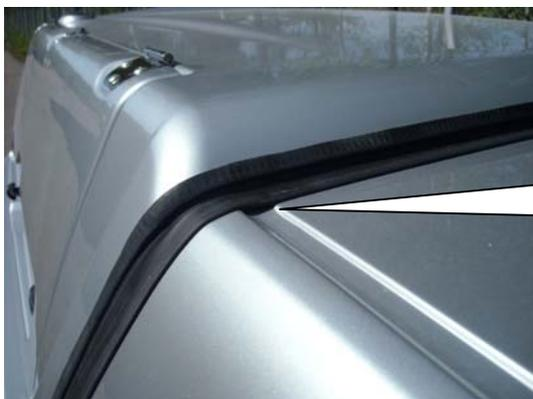
Auf dem Dach des Fahrzeuges zwischen Lippendichtung und dem „Graben“ auf dem Dach mit Butylklebestreifen abdichten.
