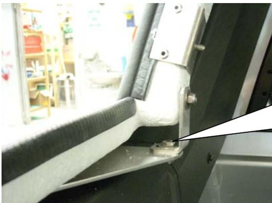
Montieren Sie jetzt die vordere Winkelbefestigung an den Befestigungsbeschlag und verwenden Sie dafür die Schraube M6\*16 sowie Gegenmutter und Unterlegscheiben an beiden Seiten. **ACHTUNG!** Die Muttern noch nicht festziehen. Machen Sie das Gleiche auf der anderen Seite.
