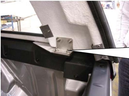
Montieren Sie die hintere Winkelbefestigung mit Vorrichtung ohne Gummidichtung von der Unterseite des Befestigungsbeschlages mit Gegenmutter und Unterlegscheibe. **ACHTUNG!** Die Muttern noch nicht festziehen. Machen Sie das Gleiche auf der anderen Seite
