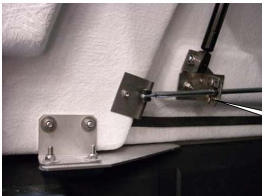
Kontrollieren Sie dass die Klappen leicht zu schließen sind, und dass die Verriegelungsschlösser richtig eingestellt sind. Bei Bedarf diese nach oben auf dem Gleitwinkel justieren.
