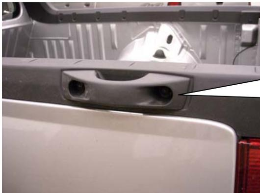
Beginnen Sie mit der Demontage der acht Befestigungsösen an der Außenseite der Pritschenkante. Die Schrauben der Befestigungsösen werden für die Befestigungsbeschläge der Haube verwendet.
