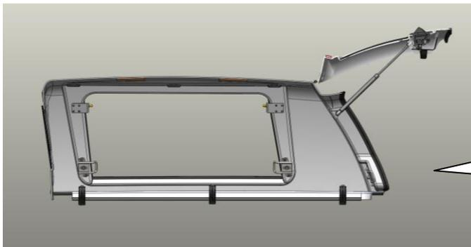
Drücken Sie die Haube seitlich gegen die Innenkante der Pritsche und befestigen Sie die Klammern wie auf dem Bild. Die Haube auf der Pritschenkante mit den Klammern festziehen mit **Max. 10Nm**.
