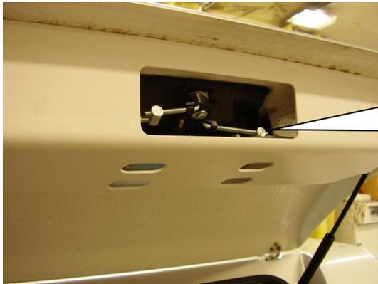
Sie können beim mittleren Schloss die Länge der Schließstangen verändern indem Sie den Kunststoffclip lösen und die Schließstange drehen die an der Verbindung zum Schlosshaken ein Gewinde hat.
