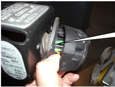
Das Bremslicht soll gemäß der Anweisung von Ford zwischen Anhängerkontakt und Stecker angeschlossen werden.
