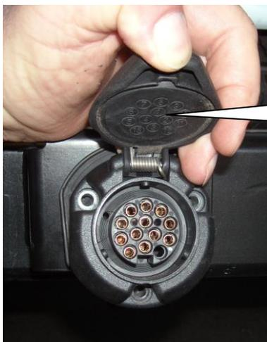
Die Verbindungen sind nummeriert, wie an der Innenseite des Deckels zu sehen ist. Bremslicht plus Kabel wird in Nr.6, Farbe: lila/weiß und minus Kabel (Erde) in Nr. 3 angeschlossen Farbe: schwarz/grau
