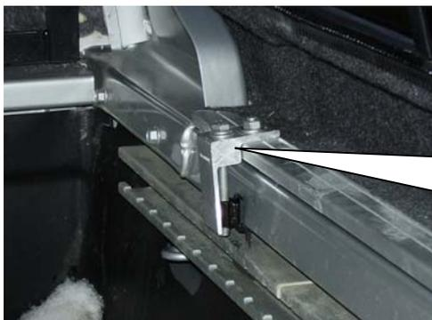
Befestigen Sie die Haube an der Pritschenkante mit den Befestigungsbeschlägen laut Abb. Bei einigen Modellen ist es vielleicht notwendig die Pritschenverkleidung einzukerben damit die Beschläge unter die Pritschenkante greifen können.
