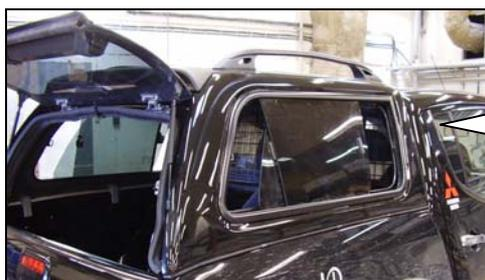
Stellen Sie die Haube auf ihren Platz und ziehen Sie diese zurück, sodass die Rückseite des Führerhauses nicht verschrammt wird und außerdem so an der hinteren Kante platziert ist, dass die Haubenklappe die Pritschenkante abdichtet. Die Klappe muss gleichzeitig in einer Linie mit der Haube sein.
