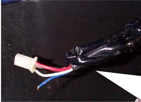
An der rechten Innenseite verlaufen die Kabel für das hohe Bremslicht und die Innenbeleuchtung. Diese müssen laut Anweisung des Generalagenten und laut Wunsch des Kunden angeschlossen werden.
