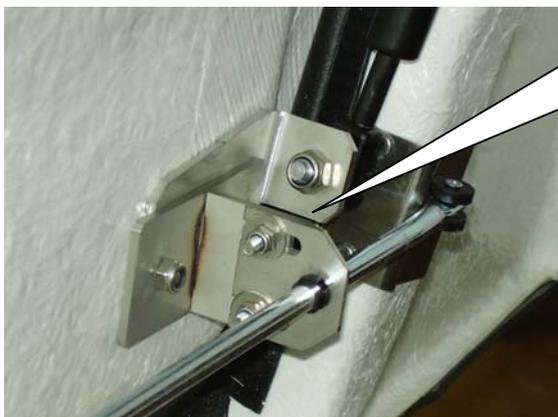
Kontrollieren Sie auch, dass die Klappen leicht zu öffnen und zu schließen sind, und dass die Schösser korrekt eingestellt sind. Bei Bedarf ist die Höhe des Gleitwinkels zu ändern.
