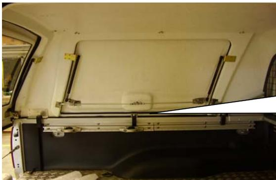
Bringen Sie die Befestigungsklammern wie auf dem Bild an und ziehen Sie diese mit **max. 10 Nm** fest.
