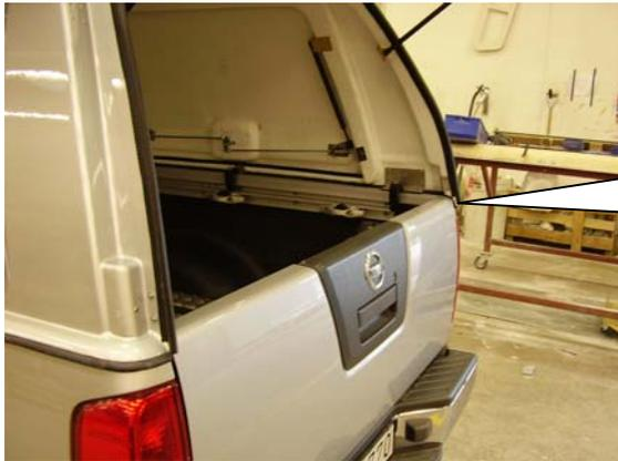
Drücken Sie die Haube so auf die Pritsche, dass die Haubenrippe an der Außenseite der Pritschenkante anliegt
