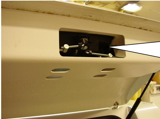
Am Schloss in der Mitte besteht die Möglichkeit die Länge der Verriegelungsstangen zu verändern, indem sie die Kunststoffclips lösen, und die Verriegelungsstange, die an der Verbindung zum Schlosshaken ein Gewinde hat, drehen.
