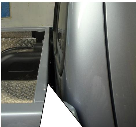
Reinigen Sie die Pritschenkante und bringen Sie die selbstklebende Dichtungsleiste auf der oberen vorderen Kante der Pritsche an, sodass diese zwischen Haube und Vorderteil abdichtet.
