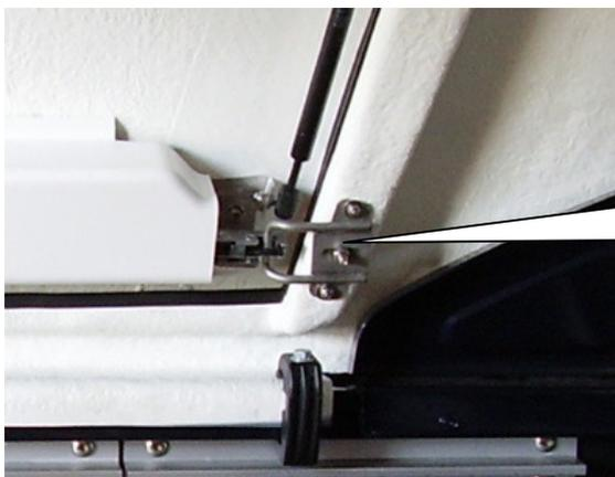
Kontrollieren Sie, dass die Klappen leicht zu schließen sind und das die Schlösser richtig eingestellt sind. Bei Bedarf das Schloss und den Schlossriegel justieren.
