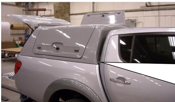
Heben Sie die Haube vorsichtig auf den vorgesehenen Platz auf das Fahrzeug und drücken Sie diese so zurück, dass sie an der Dichtungsleiste, wie oben anliegt. Schließen Sie die Heckklappe vorsichtig und kontrollieren Sie, dass diese nicht an der Ladefläche scheuert und die Heckklappe abdichtet. Eventuell muss die Haube nach vorn oder hinten verschoben werden.
