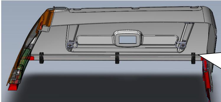
Zentrieren Sie die Haube seitwärts auf der Ladefläche und befestigen Sie die Klammern wie auf der Abbildung. Die Haube mit den Klammern fest an der Pritschenkante anziehen. **Achtung: Max 10Nm Anziehungsmoment.**
