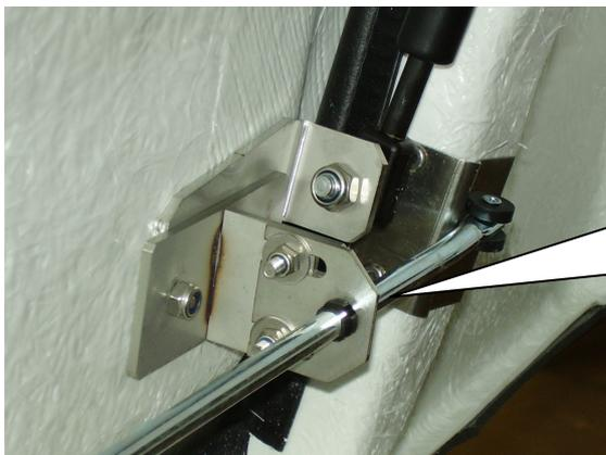
Kontrollieren Sie, dass die Klappen leicht zu schließen sind und dass die Schösser richtig eingestellt sind. Bei Bedarf wird die Höhe des Gleitwinkels geändert.
