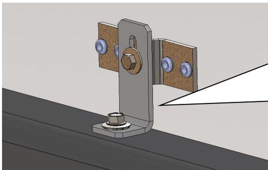
Montieren Sie die Stirnwandbefestigungen laut Abbildung. Bringen Sie die Befestigung nach unten an der Pritschenkante an und schrauben Sie diese am vorhandenen Beschlag der Haube fest. Ziehen Sie mit Hilfe der Befestigungen die Stirnwand zurück und markieren Sie gleichzeitig die Stelle auf der Pritschenkante, wo das Loch für die selbstschneidende Schraube gebohrt werden muss. Bohren Sie das Loch 4,9- 5,0 tief in den vorderen Teil und ziehen Sie danach die Schraube fest an.
